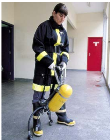
Fig. 68: colocação do cilindro com o suporte passando um dos braços por um dos arreios.
