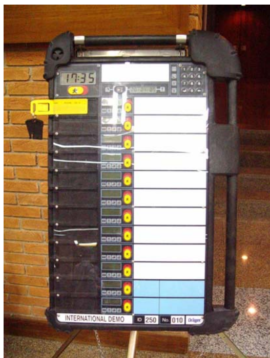
Fig. 72: quadro de controle de proteção respiratória
