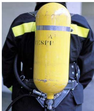
Fig. 61: cilindro de aço carbono
