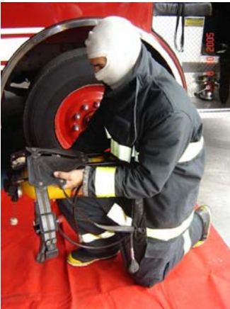
Fig 39. apóie o cilindro sobre o joelho e segure lateralmente no suporte com a válvula voltada para frente
